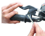
1. Use a chave Allen M3 para ajustar corretamente o freio.
