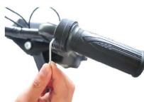
2. Use a chave Allen M2.5 para ajustar corretamente o guidão
